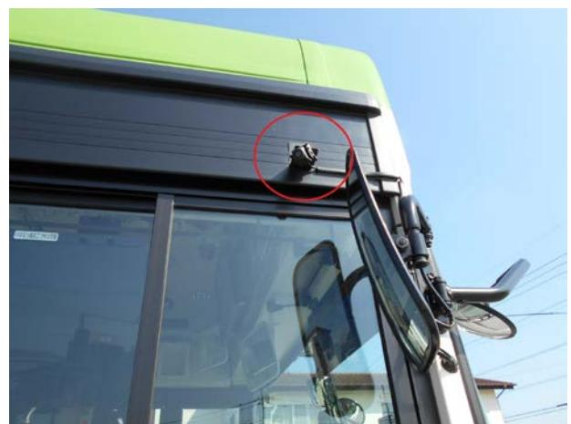
\* 全車両にデジタルタコグラフ内蔵型ドライブレコーダーを設置しています。
